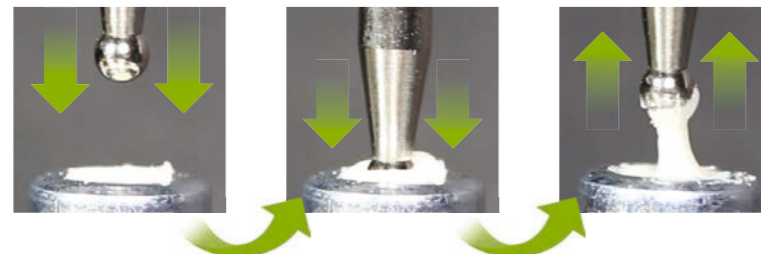
Abb. 6: Prüfverfahren: Der Stopfer wird in die angemischte Paste eingetaucht und unmittelbar danach wieder zurückgezogen.
